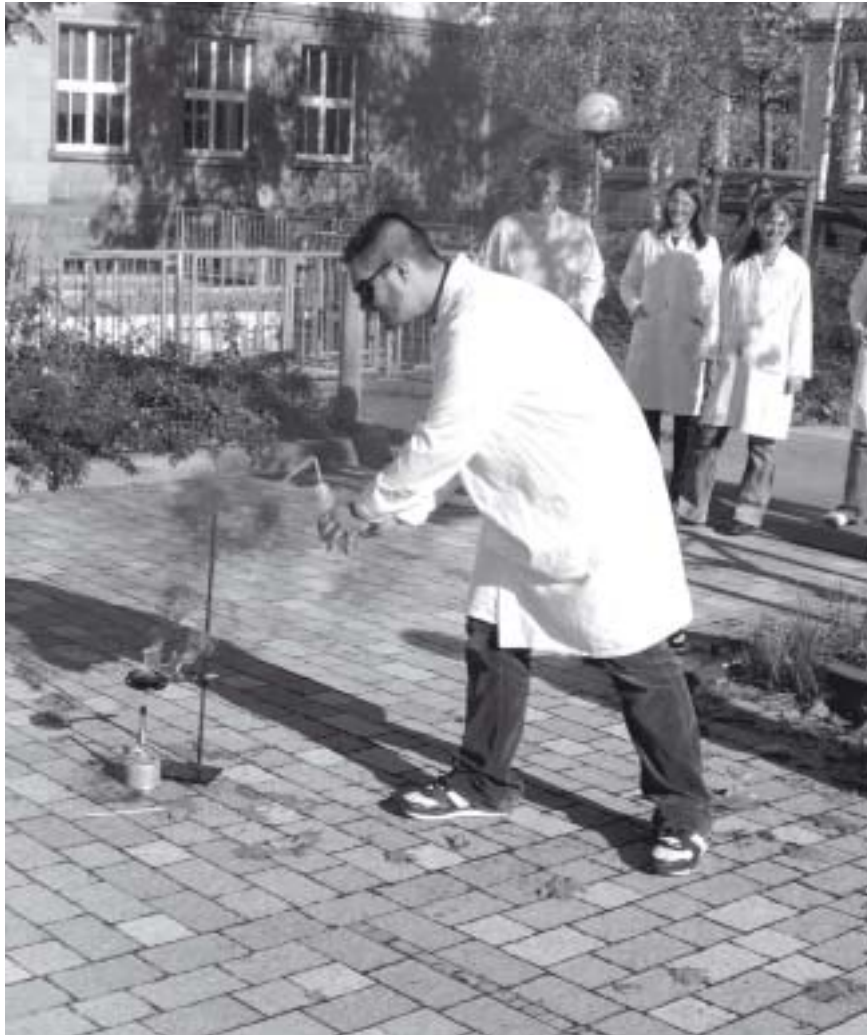
Lehrveranstaltung »Chemische Schulexperimente I«: Gefahren aus dem Alltag im Experiment deutlich zu machen (hier: Löschen eines Fettbrandes mit Wasser), ist ein wichtiges Anliegen des Chemieunterrichts.
